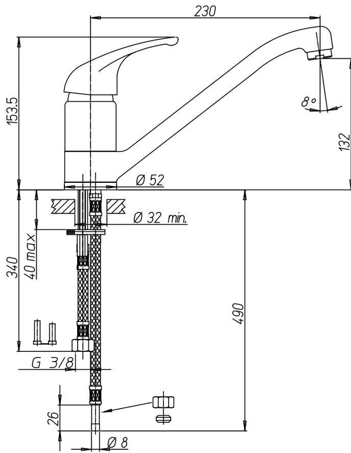
**ESEMPIO DI INSTALLAZIONE IDRAULICO EXAMPLE OF INSTALLATION**
